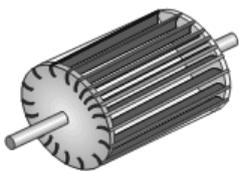
La turbine Banki est une évolution des roues à aube. Le flux d'eau est transversal, c'est-à-dire que l'eau s'écoule au travers des pales de la turbine. L'eau entre par un des côtés de la turbine et en ressort par le côté opposé. L'eau traverse ainsi deux fois les pales de la turbine. Le rendement d'une turbine Banki est de l'ordre de 80 %.
